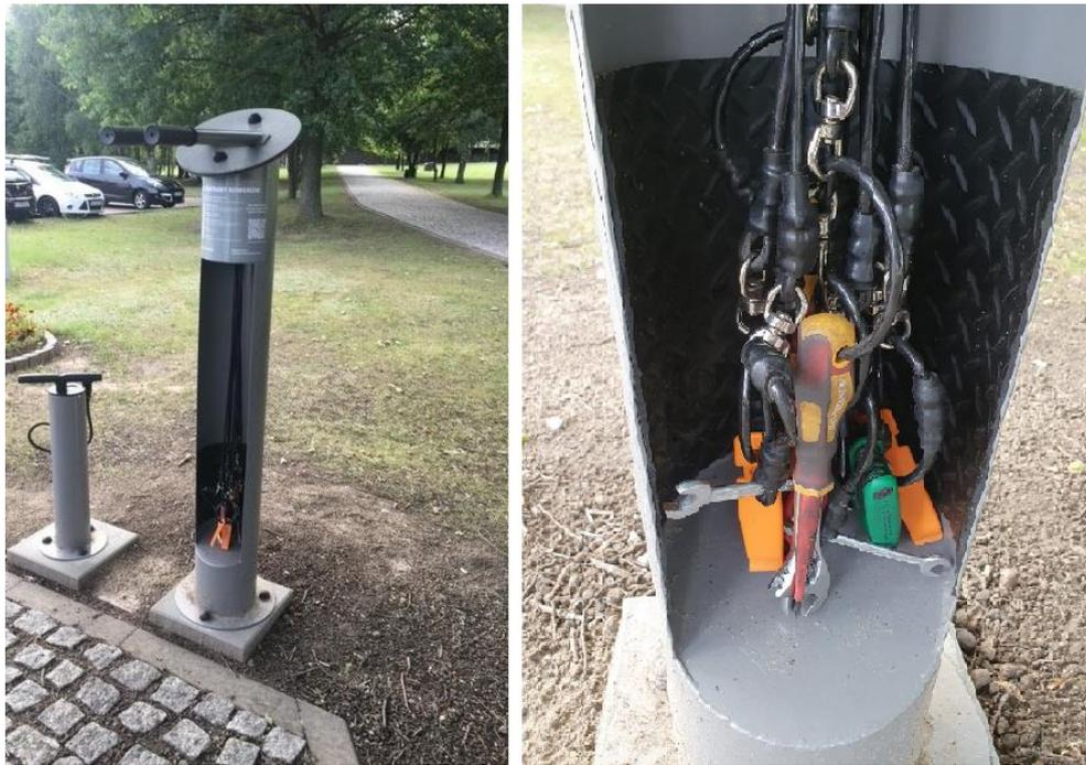
Abbildung 17 Radservicestation zur Selbsthilfe im Kreis Gnieźnieński (Polen) (LK Teltow-Fläming 2023)
